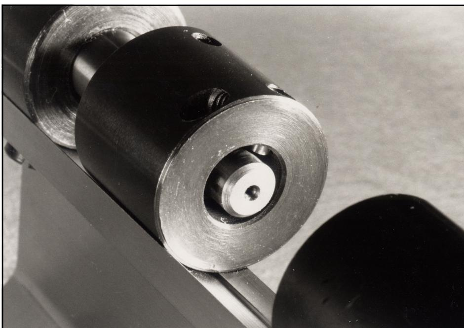
En plein tournage. La pastille de carbure attaque le collet et détache un copeau.
